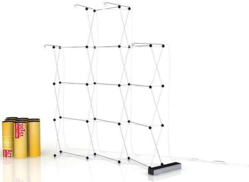
**3. Установить магнитные направляющие в пластиковые узлы каркаса в вертикальном положении. Сначала установить нижний ярус направляющих, затем средний и верхний.**
